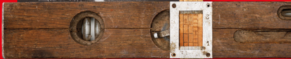
1949 — NT4 Neigungs-Wasserwaage aus Holz
